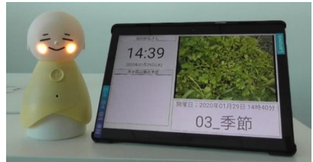
図1 写真を用いた対話で高齢者の認知的健康を育む対話ロボットシステム
