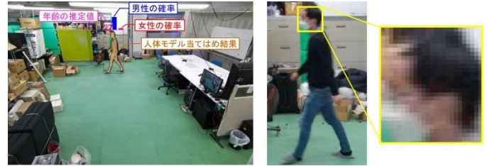
図 3. 歩容による属性推定結果 (左) と入力画像の人物領域及び頭部領域の拡大図 (右)
